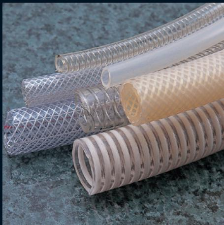
軟質樹脂やゴム単体で作られているものを「チューブ」、糸や布、ワイヤーなどで補強されているものを「ホース」と呼びます。（ビニールホースは、口径が大きいものが多く使用されてきたためか、樹脂単体ですが「ホース」と呼ばれています。）
